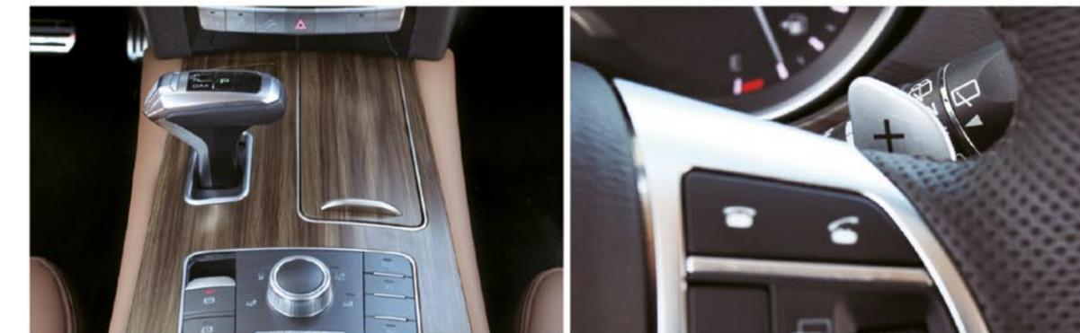
8-ступенчатая автоматическая коробка передач ZF с возможностью ручного переключения
